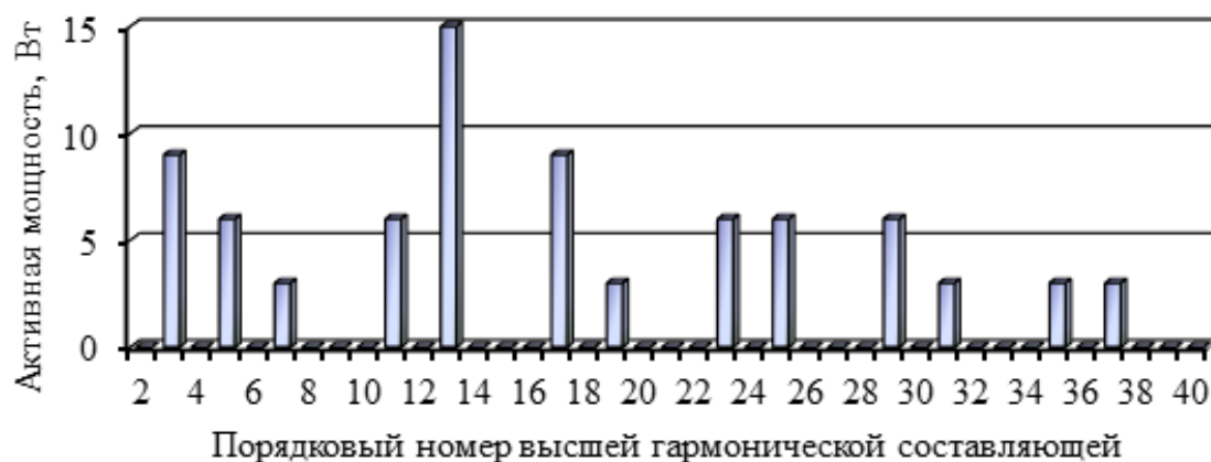
Рис. 2. Гистограммы гармонических составляющих от 1-й до 40-й для фазы L1: измеренные с помощью анализатора качества электрической энергии Энергомонитор 3.3 Т, установленного во вводной ячейке, питающей шины НН трансформаторной подстанции: а – напряжения; б – силы тока; в – активной мощности / Fig. 2. Histograms of harmonic components from the 1st to the 40th for the L1 phase: measured using an electric energy quality analyzer Energy monitor 3.3 T installed in the input cell feeding the NN bus of a transformer substation: a – voltage; b – current; c – active power
