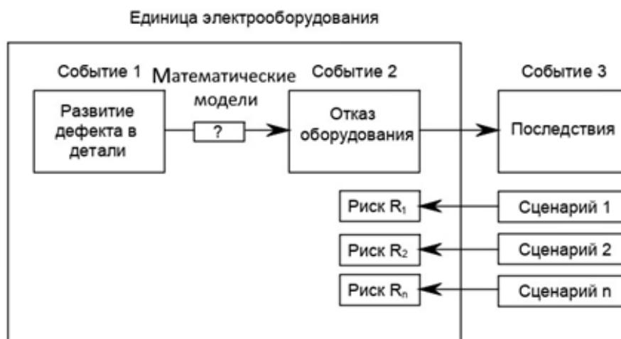
Рис. 1. Причинно-следственная связь между дефектами и отказами элементов СЭС /
