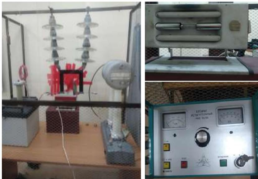
Рис. 1. Общий вид экспериментальной установки, кварцевый излучатель и высоковольтная установка АИД-70 /
