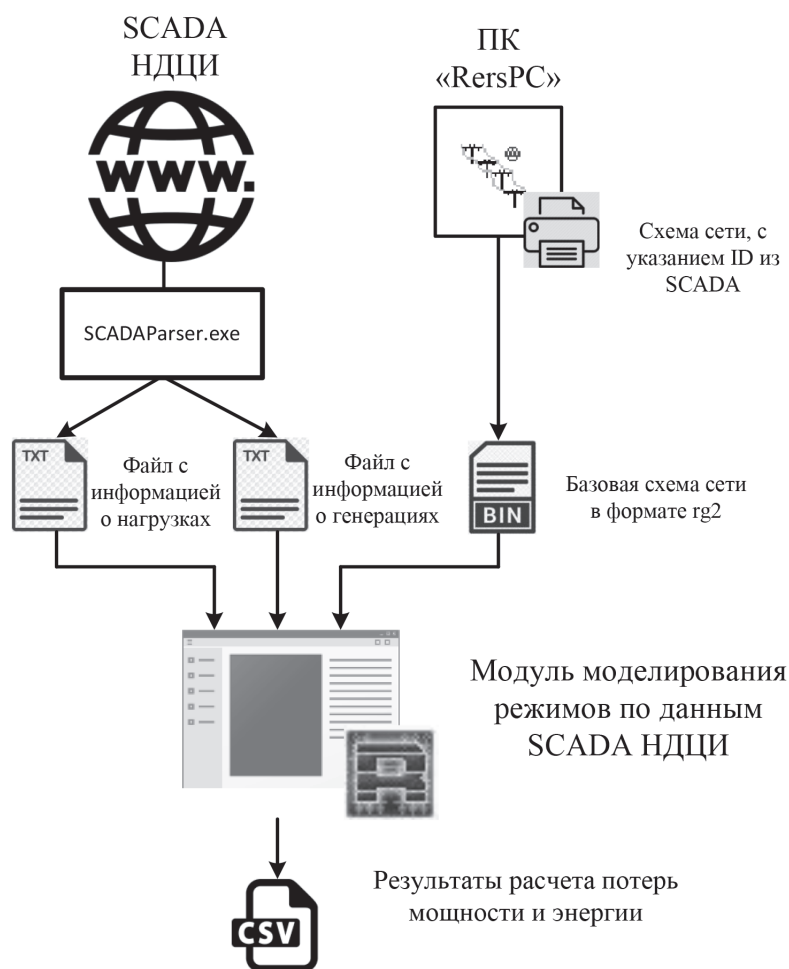
Рис. 3. Схема взаимодействия программных комплексов RersPC, RastrWin при моделировании текущих режимов по данным SCADA НДЦИ
