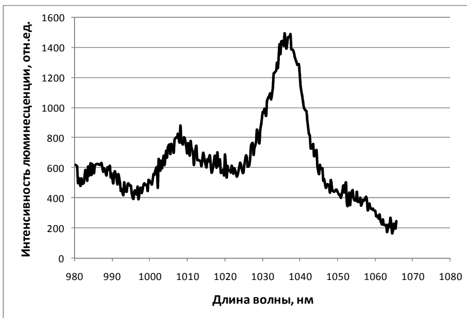
Рис. 2. Фрагмент спектра люминесценции твердого раствора (Y_{0.9-x}Yb_{0.1}Tm_x)_3Al_5O_{12} в области 0,98–1,07 мкм при возбуждении лазерным излучением с длиной волны 940 нм
