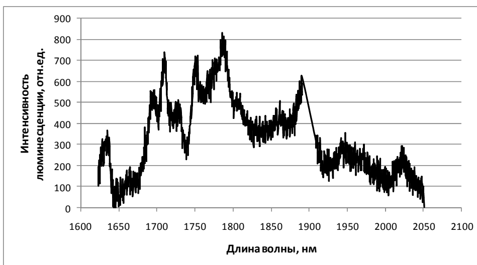
Рис. 3. Фрагмент спектра люминесценции твердого раствора (Y_{0.9-x}Yb_{0.1}Tm_x)_3Al_5O_{12} в области 1,6–2,05 мкм при возбуждении лазерным излучением с длиной волны 940 нм
