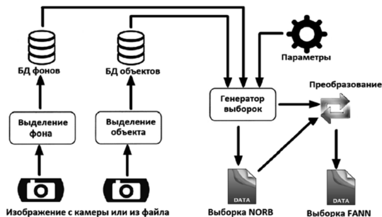
Рис. 1. Логическая структура программы-генератора обучающих выборок для нейронных сетей
