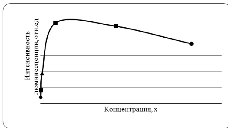
Рис. 5. Зависимость интенсивности стоксовой ИК-люминесценции твердых растворов (Y_{0,85-x}Yb_{0,1}Er_{0,05}Ho_x)_3Al_5O_{12} в области 2100 нм от концентрации ионов Ho^{3+}
