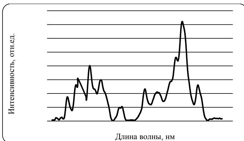
Рис. 4. Фрагмент спектра стоксовой ИК-люминесценции твердых растворов (Y_{0,85-x}Yb_{0,1}Er_{0,05}Ho_x)_3Al_5O_{12} в области 1830–2150 нм при возбуждении лазерным излучением с длиной волны 940 нм
