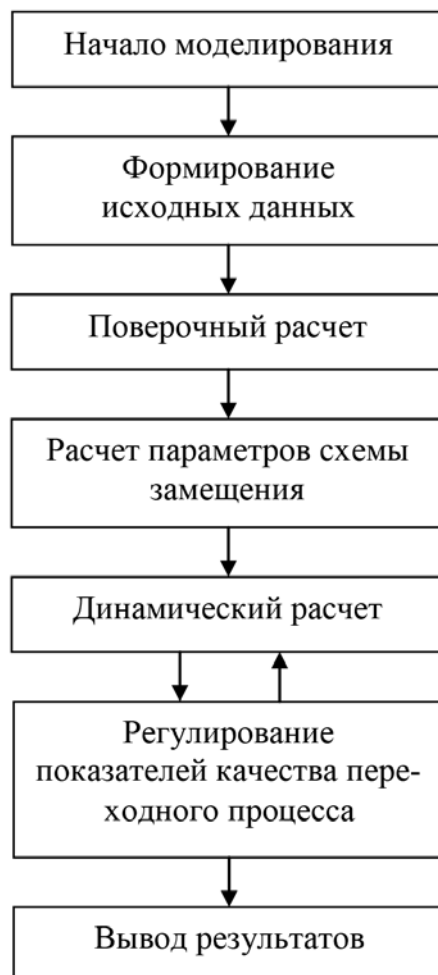
Рис. 1. Алгоритм моделирования двигателя постоянного тока с подчиненной системой регулирования параметров
