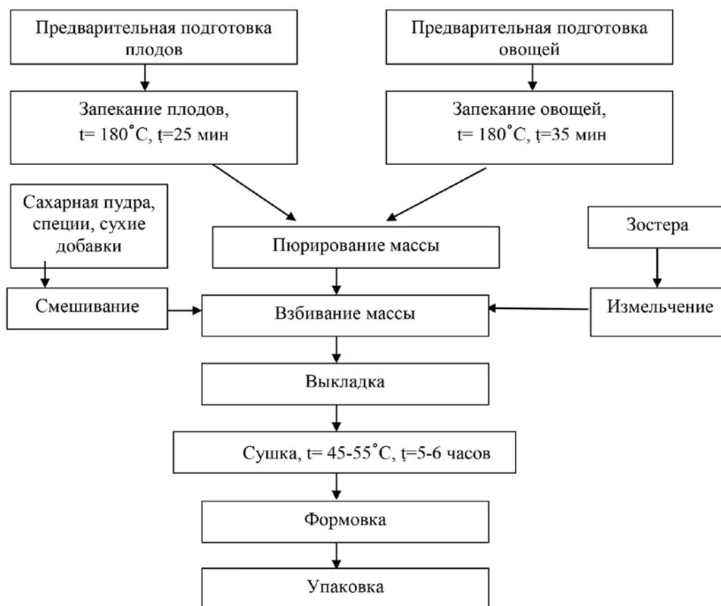
Рис. 2. Технологическая схема производства фруктово-овощной пастилы
