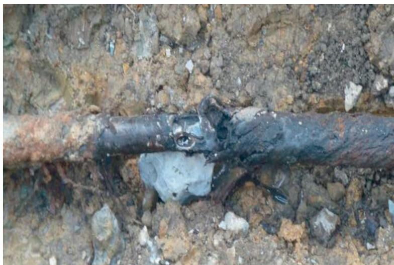
Рис. 1. Пример прожига оболочки и брони кабельной линии
