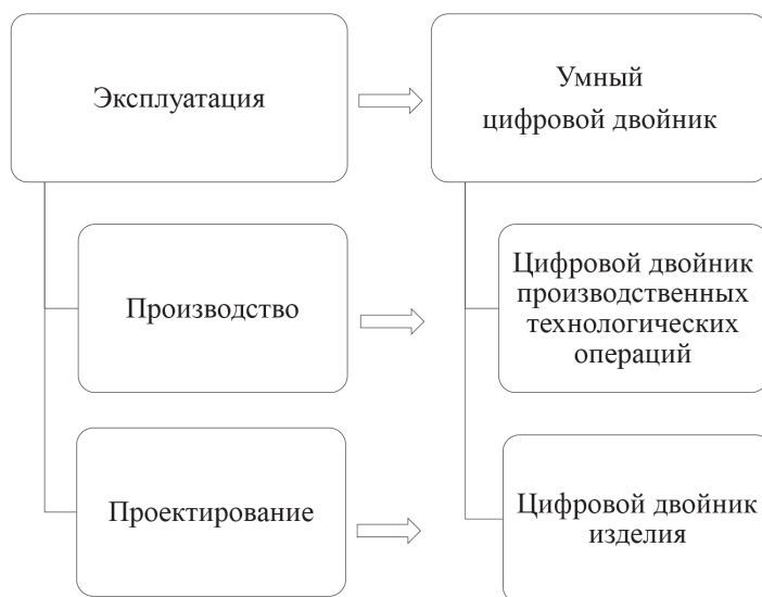
Рис. Формирование цифрового двойника по этапам создания и эксплуатации промышленной продукции
