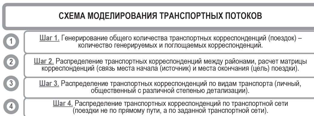
Рис. 2. Схема моделирования транспортных потоков
