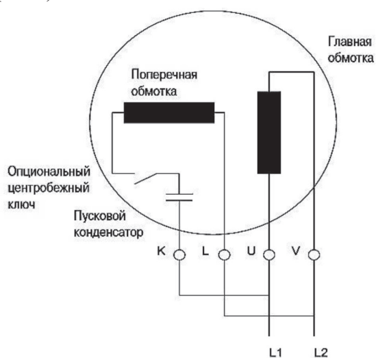
Рис. 6. Схема пуска АД через конденсатор
