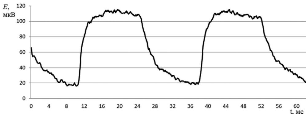
Рис. 5. Временные диаграммы фото-ЭДС образца ZnS:CuCl
