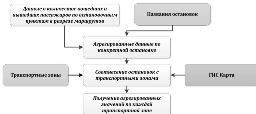
Рис. 6. Алгоритм расчета пассажиропотоков по транспортным зонам
