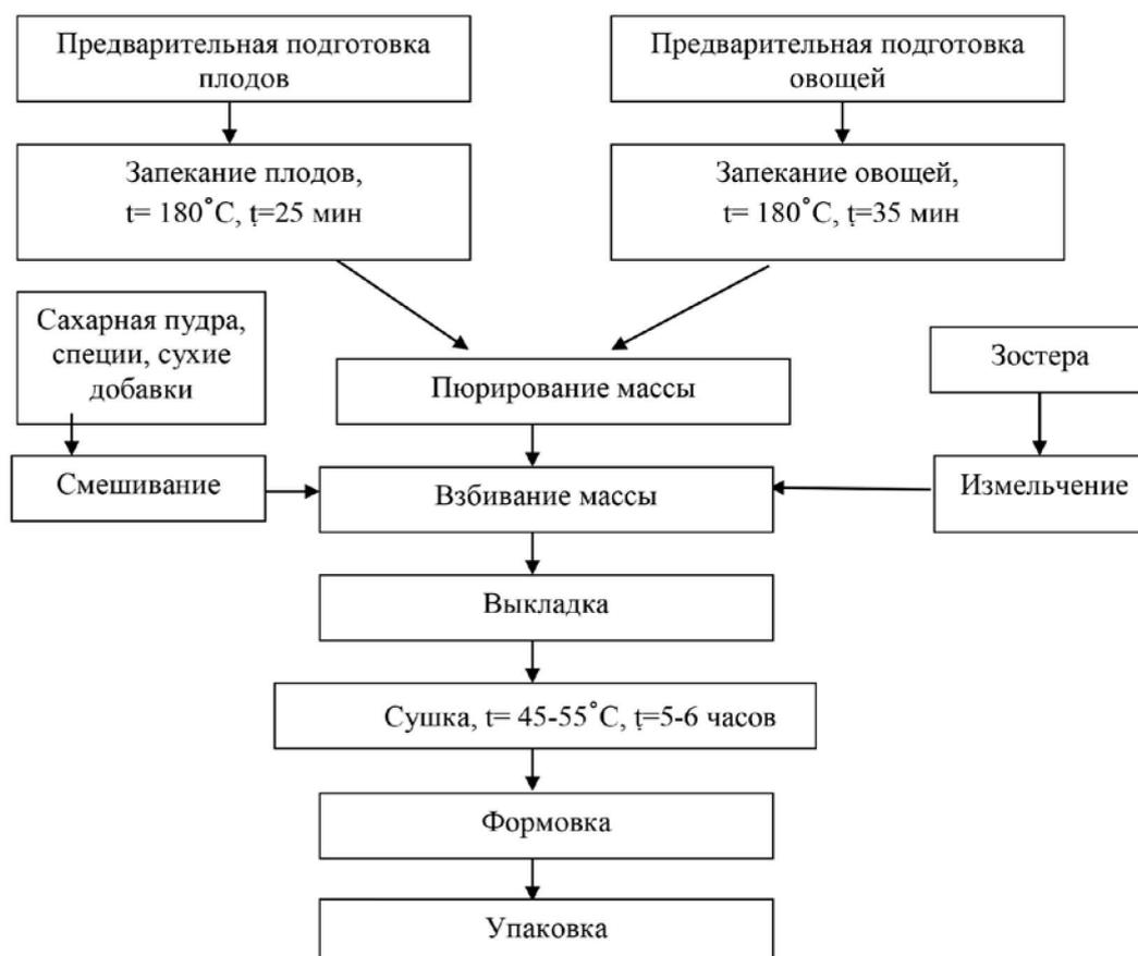
Рис. 2. Технологическая схема производства фруктово-овощной пастилы
