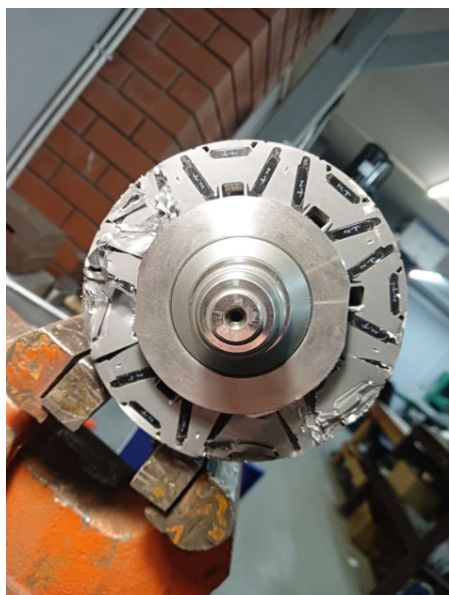
Рис. 4. Ротор электродвигателя JEE EI09M-CW-M-007 /
