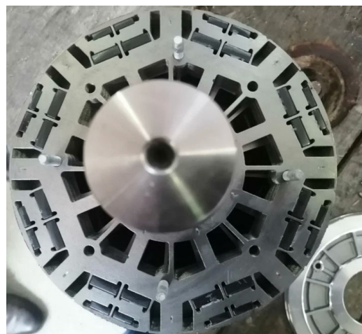
Рис. 1. Ротор электродвигателя Geely TZ220XS140 /
