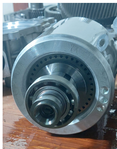
Рис. 7. Ротор электродвигателя Huawei YS210XY1P5 /
