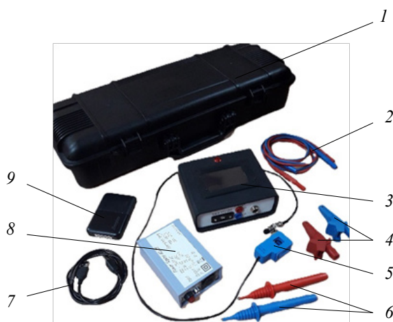
Рис. 1. Цифровой измеритель параметров однофазных электроприемников: 1 – кейс для транспортировки измерителя; 2 – соединительные провода для подключения к измерительной цепи напряжения; 3 – цифровой измеритель параметров однофазных электроприемников; 4 – щупы типа «крокодил» для подключения к измерительной цепи напряжения; 5 – токовая клеща для подключения к измерительной цепи тока; 6 – щупы типа «штырь» для подключения к измерительной цепи напряжения; 7 – кабель питания; 8 – блок питания от сети; 9 – блок питания от аккумуляторной батареи для работы в автономном режиме / Fig. 1. Digital meter for measuring parameters of single-phase electric consumers: 1 – case for transporting the meter; 2 – connection wires for connection to the voltage measuring circuit; 3 – digital meter for measuring parameters of single-phase electric consumers; 4 – alligator probes for connection to the voltage measuring circuit; 5 – current clamp for connection to a current measuring circuit; 6 – pin type probes for connection to the voltage measuring circuit; 7 – power cable; 8 – mains power supply; 9 – battery power supply for autonomous operation.
