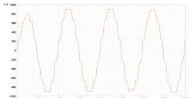
Рис. 8. Осциллограмма тока на стороне ВН трансформатора преобразователя / Fig. 8. Current oscillogram on the transformer converter HV side
