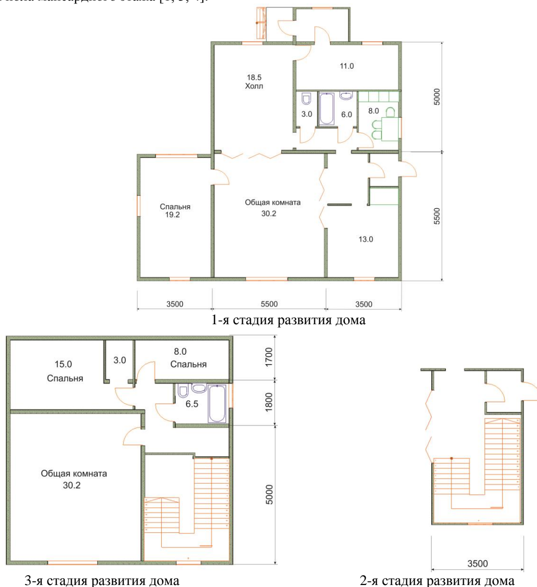
Рис. 1. Схема трехстадийного развития планировки одноквартирного индивидуального жилого дома, «растущего» по вертикали
