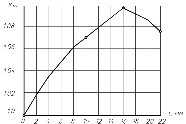
Рис. 2. Зависимость коэффициента изменения микротвердости от расстояния от места облучения (доверительный интервал: \Delta K_{HV} = \pm 0,0224 )
