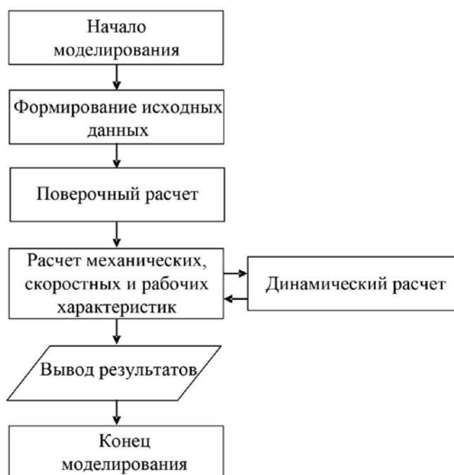
Рис. 1. Алгоритм функционирования поверочного расчета, дополненного модулем динамического расчета
