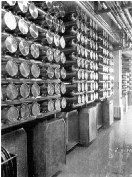
Рис. 5. Ультрафильтрационная установка производительностью 180 т молочной сыворотки в сутки
