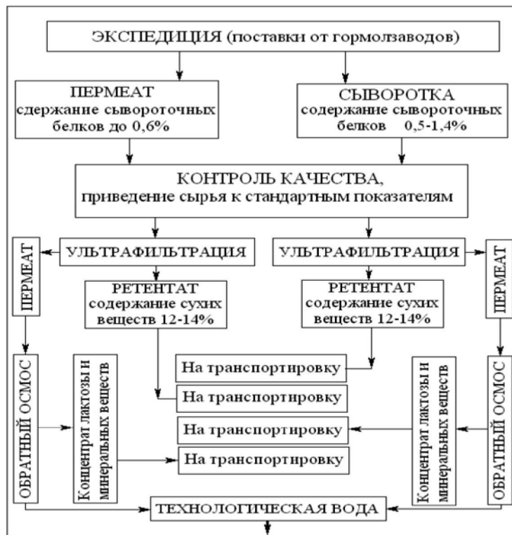
Рис. 4. Логистика замкнутой технологической блок-схемы централизованной переработки творожной сыворотки
