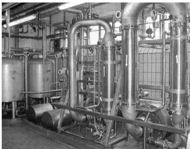
Рис. 2. Микрофилтративная установка производительностью 300 т молочной сыворотки в сутки
